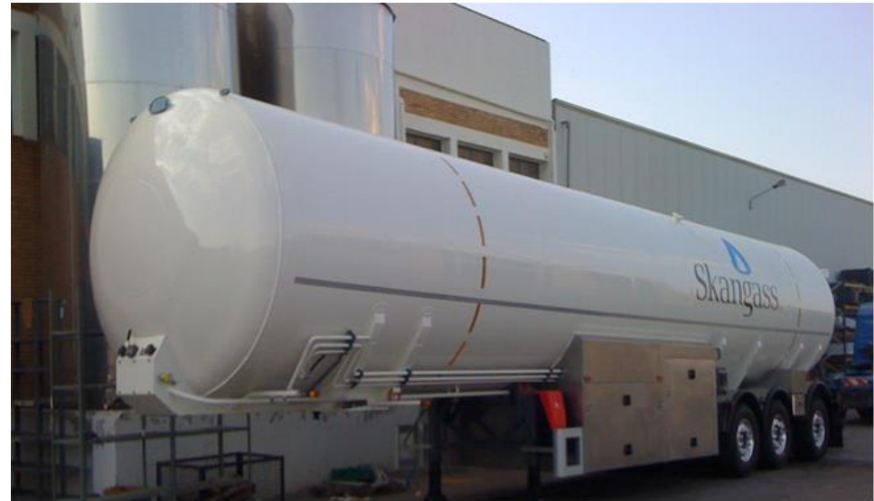
LNG Semitrailer, 58m 3
