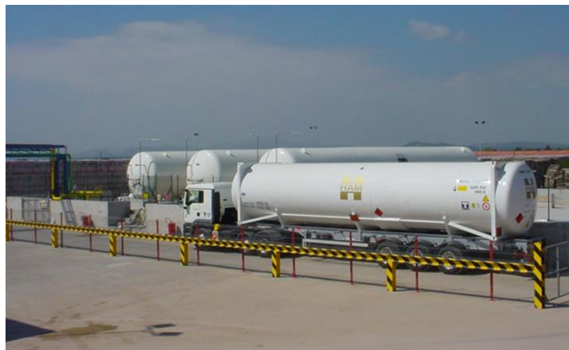
LNG 45 feet Container unit, 54m3
